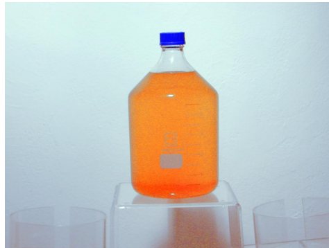
Entfettungsbad 6000 mg/l CSB 1
